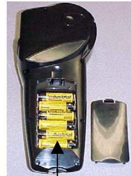
Cubierta del compartimiento para pilas
